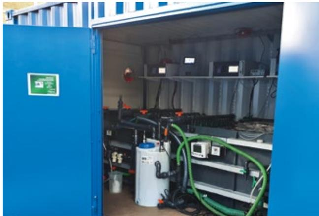
Blick in den Technikcontainer der Pilotanlage, in dem die biologische Brennstoffzelle aufgebaut ist
